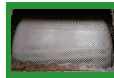
松滋葛洲坝使用2年，柱钉磨损0.8mm
